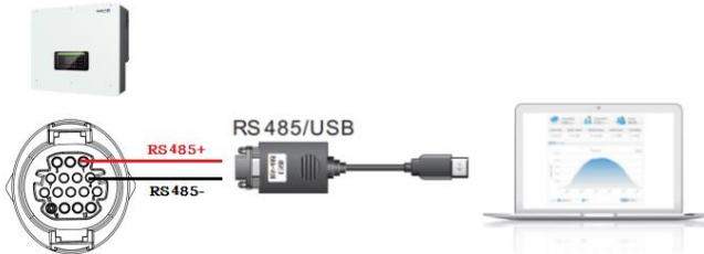
Si necesita utilizar el software del ordenador superior, por favor, consulte con el personal de soporte técnico post-venta de SOFARSOLAR. El software del ordenador superior se puede utilizar para establecer la habilitación y los parámetros de control de potencia, los parámetros de desprendimiento de carga de sobretensión y subtensión, los parámetros de desprendimiento de frecuencia de sobretensión y subtensión, y la habilitación y el ajuste de los parámetros de salida de potencia reactiva.
